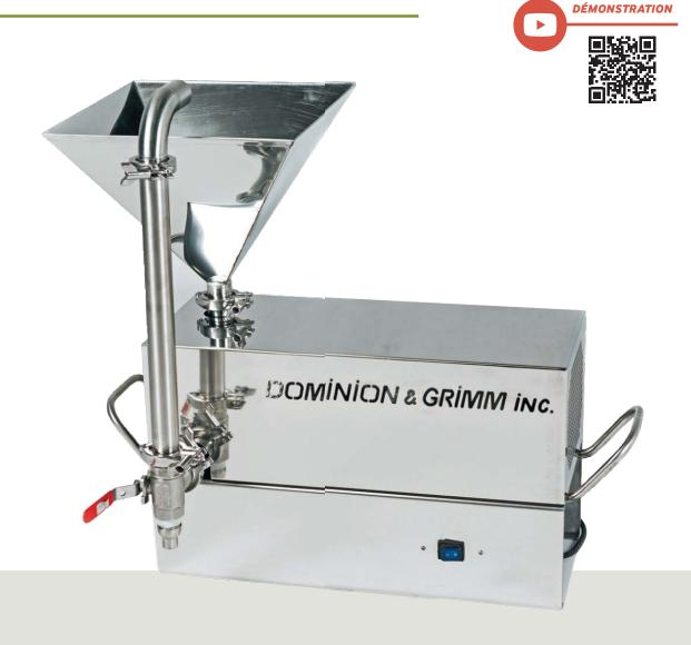
Malaxeur pouvant contenir 2 gallons de sirop. Moteur 3/4 hp - 110V. Pompe laiton 1" "Oberdorfer". Plomberie montée sur ferrules entièrement démontable en acier inoxydable pour le lavage rapide de la cuve de la plomberie.
